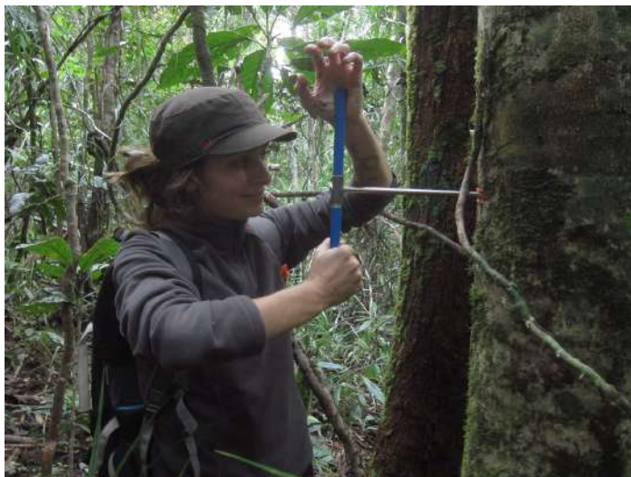
FIGURE 2.14 – Extraction d'une carotte de bois depuis un arbre à l'aide d'une tarière par un membre de l'équipe
