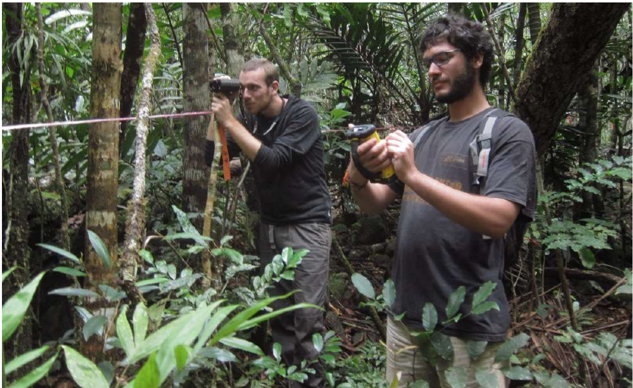
FIGURE 2.17 – Un membre de l'équipe vise les cibles réfléchissantes au laser et l'autre classe les coordonnées reçues par bluetooth
